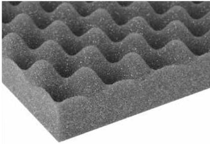
Der Noppenschaum ist ein Schallabsorber mit extrem vergrößerter Oberflächenstruktur. Dank seiner gewellten Oberflächenstruktur wird eine sehr gute, breitbandige Schallabsorption erzielt. Der Noppenschaum besteht aus einem feinporigen, flexiblen Polyuretanschaum mit offener luftdurchlässiger Struktur.
